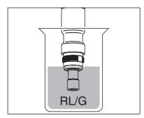
Sensorkopf bis einschließlich zur Gegenelektrode in Reinigunglösung RL/G tauchen.
