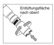
Sensor schräg halten und den Membrankopf mit einem Papiertuch handfest aufschrauben. Überschüssige Elektrolytlösung drückt an der Entlüftungsfläche heraus.
