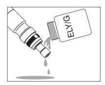
Sensorkopf mit Elektrolytlösung spülen.
