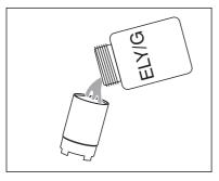
Einen neuen Membrankopf mit Elektrolytlösung ELY/G füllen.
