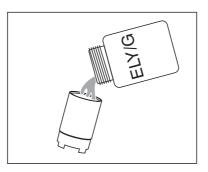
Einen neuen Membrankopf mit Elektrolytlösung ELY/G füllen.
