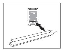
Vorhandene Luftblasen durch vorsichtiges Klopfen entfernen. Sie können Luftblasen zusätzlich verhindern, indem Sie die erste Füllung verwerfen und noch einmal befüllen.
