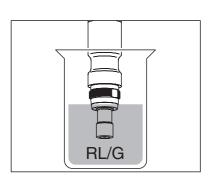
Sensorkopf bis einschließlich zur Gegenelektrode in Reinigunglösung RL/G tauchen.
