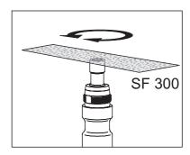
Mit der rauhen Seite der **nassen** Schleiffolie SF 300 Verunreinigungen von der Gold-Arbeitselektrode mit leichtem Druck abpolieren.
