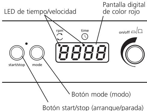
Cuando aparezca la velocidad correcta, pulse el botón start/stop (arranque/parada) para poner la unidad en movimiento. La velocidad se puede ajustar sin detener la unidad. La unidad se puede detener en cualquier momento pulsando el botón start/stop (arranque/parada). Si se abre la puerta mientras la unidad está en movimiento, se oirá una alerta de advertencia y la unidad dejará de moverse. La palabra "door" (puerta) también aparecerá brevemente en la pantalla. Cierre la puerta para continuar.
