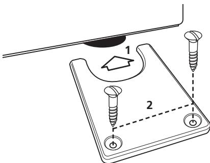
Assicurarsi che l'unità sia stata posizionata correttamente. Dai lati dell'unità, collocare ciascun supporto intorno a uno dei piedini posteriori (1). Fissare i supporti mediante due viti N°8 x 20 mm (2).
