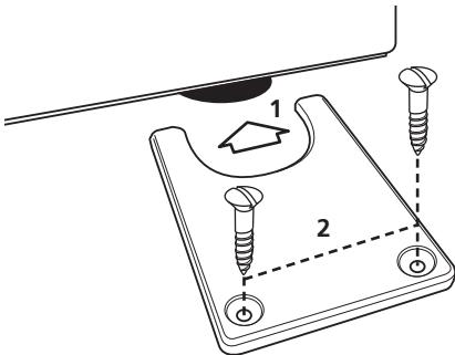
Asegúrese de que la unidad esté colocada correctamente. Desde los laterales de la unidad, deslice las abrazaderas en torno a cada una de las patas traseras (1). Fíjelas en su lugar por medio de dos tornillos n° 8 de 20 mm (2).
