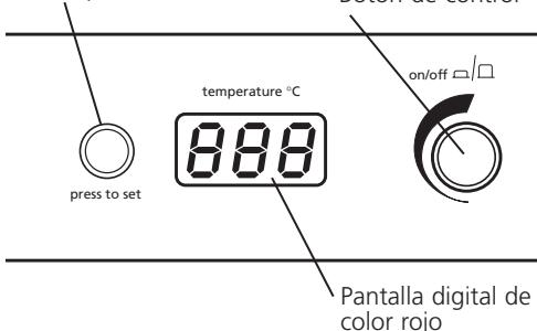
Utilice el panel de control superior para encender (ON) la unidad de control de temperatura
