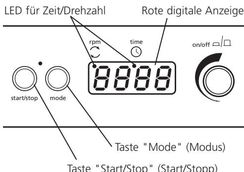
Drücken Sie die Taste "start/stop" (Start/Stopp), sobald die richtige Drehzahl angezeigt wird, um das Gerät in Bewegung zu setzen. Sie können die Drehzahl ohne Anhalten des Geräts einstellen. Sie können das Gerät jederzeit anhalten, indem Sie die Taste "start/stop" (Start/Stopp) drücken.
