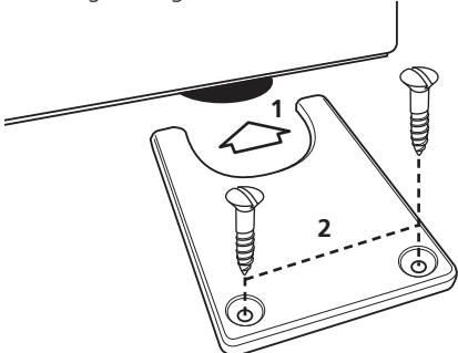
Vergewissern Sie sich, dass das Gerät richtig aufgestellt ist. Schieben Sie die Fixierungen jeweils von der Seite des Geräts um einen der hinteren Standfüße (1). Befestigen Sie die Fixierung mit 2 Schrauben (8 x 20 mm) (2).
