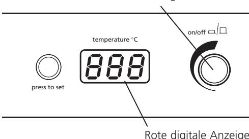
wird. Lassen Sie die Taste "press to set" (zum Einstellen drücken) los. Der Inkubator beginnt mit der Erwärmung auf die eingestellte Temperatur. Die tatsächliche Temperatur im Gerät wird am Bildschirm angezeigt. Die Mindestsolltemperatur
