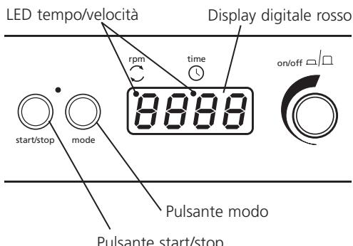
Quando sul display compare la velocità desiderata premere il pulsante start/stop per avviare il movimento. La velocità si può regolare senza fermare l'unità. L'apparecchio si può fermare in qualsiasi momento premendo il pulsante start/stop. Se durante il movimento si apre lo sportello lo strumento emette un segnale acustico e si ferma; sul display compare temporaneamente la scritta "door" (sportello). Chiudere lo sportello per continuare.
